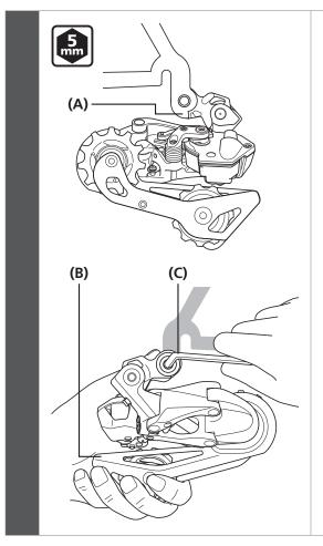
Install the rear derailleur to the frame.
